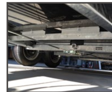
Freni ad inerzia e sospensioni a ruote indipendenti (esenti da manutenzione) per un'eccellente tenuta di strada.
